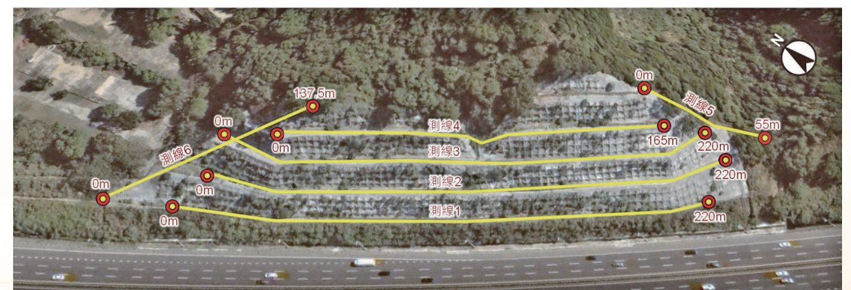
圖 7 地電阻探測測線配置圖
