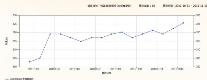
圖 8 支撐應變計監測查詢成果
