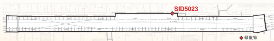
圖 14 G22 站傾度管（SID5023）位置圖
