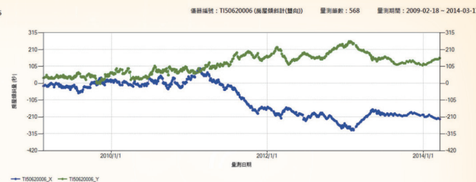
圖 9 建物傾斜計監測查詢成果
